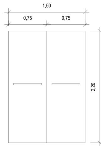
Puerta exterior de acero cortafuegos RF 90 de 220x150 cm. con dispositivo de apertura mediante palanca horizontal.
